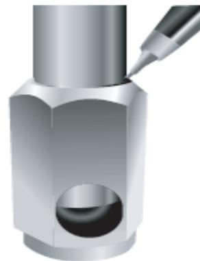
Когда трубка войдет в инструмент до упора, отметьте ее по верху глубиномера
