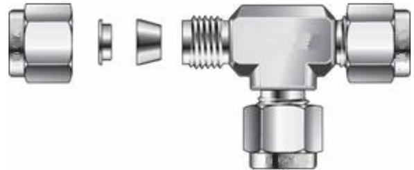
Снимите с торцевого соединения трубного обжимного фитинга гайку и обжимные кольца
