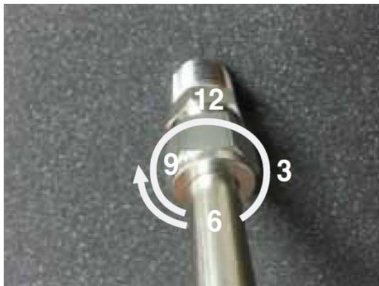
Отметить на гайке точку, соответствующую положению часовой стрелки, указывающей на 6 часов.
