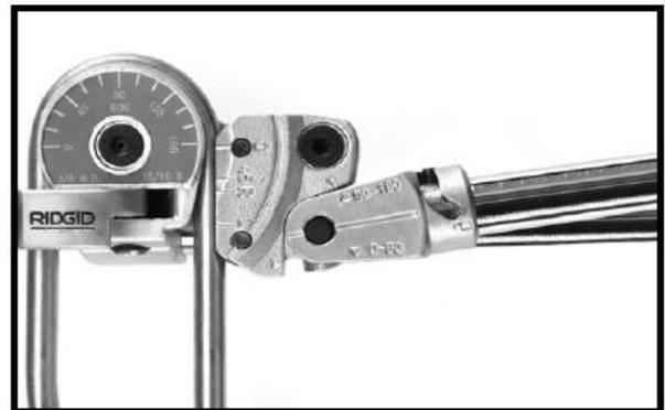
**Рис. 15 - Изгиб трубки**
