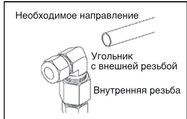
2. После затяжки трубного соединения направление колена с наружной резьбой не соответствует направлению нужного бокового отвода. Ослабление трубного соединения может привести к утечке в трубной резьбе.
