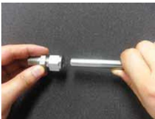
Вставить трубку в обжимной фитинг CIR-LOK до упора трубки в плечо корпуса фитинга.
